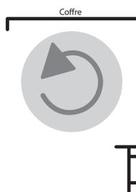
Pour **DIMINUER** la tension, faire tourner le tablier sur lui-même à l'intérieur du caisson, dans le sens de la montée.
